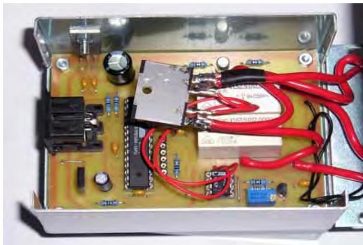
Messteil im geöffneten Gehäuse mit Shunt und Bedrahtung
