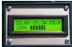
Bei vielen steht das DC Netzteil für die Funkgeräte nicht gerade im Sichtkontakt oder gar in einer Dachbodenabseite (wie bei mir). Daher wollte ich eine zentrale Anzeige für Spannung und Strom im Shack haben. Entstanden ist eine Anzeige, die folgende Funktionen/Anzeigen erfüllt:
