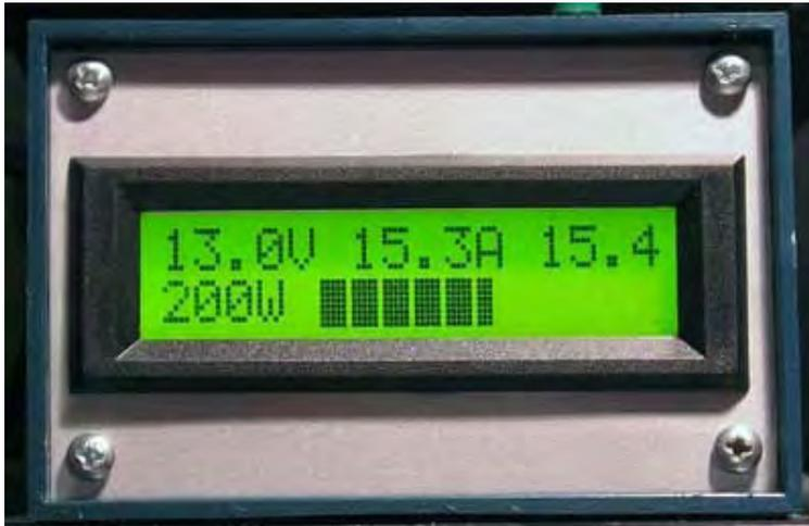
Anzeige mit Belastung und Beleuchtung 100%, unter der Power-Peak-Balken
