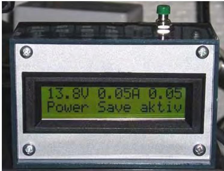
Anzeige ohne Last und Beleuchtung Aus, oben rechts der Taster, 50mA ist der Eigenbedarf
