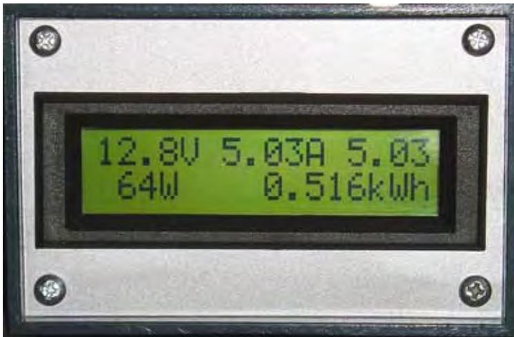
Anzeige mit Belastung und elek. Arbeit in kWh
